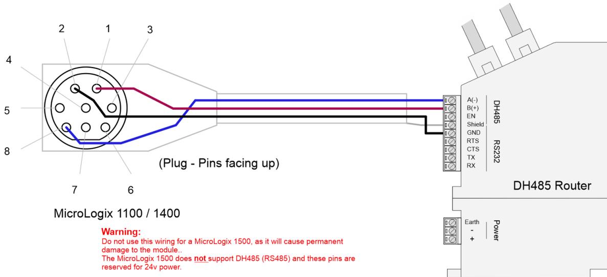
FIGURE 3.4. – SERIAL CABLE PINOUT – MICROLOGIX 1100 / 1400
