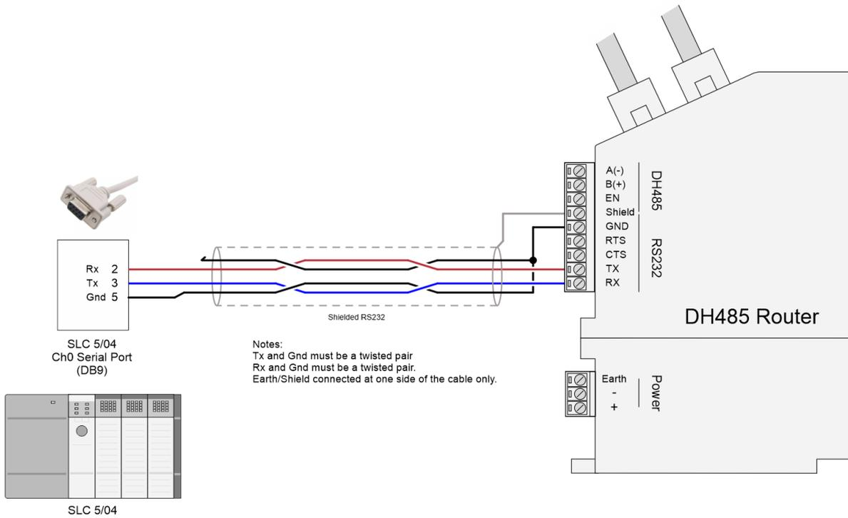
FIGURE 3.5. – SERIAL CABLE PINOUT – SLC5/04 (RS232)
