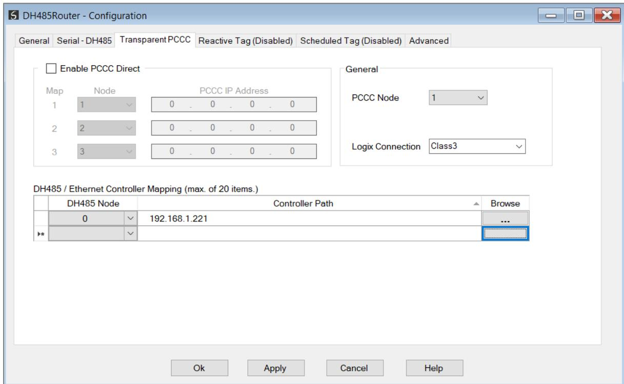
FIGURE 3.10. – TRANSPARENT PCCC CONFIGURATION
