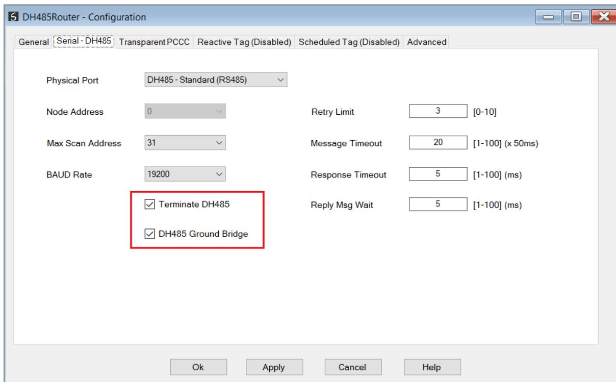
FIGURE 3.9. – DH485 SERIAL CONFIGURATION
