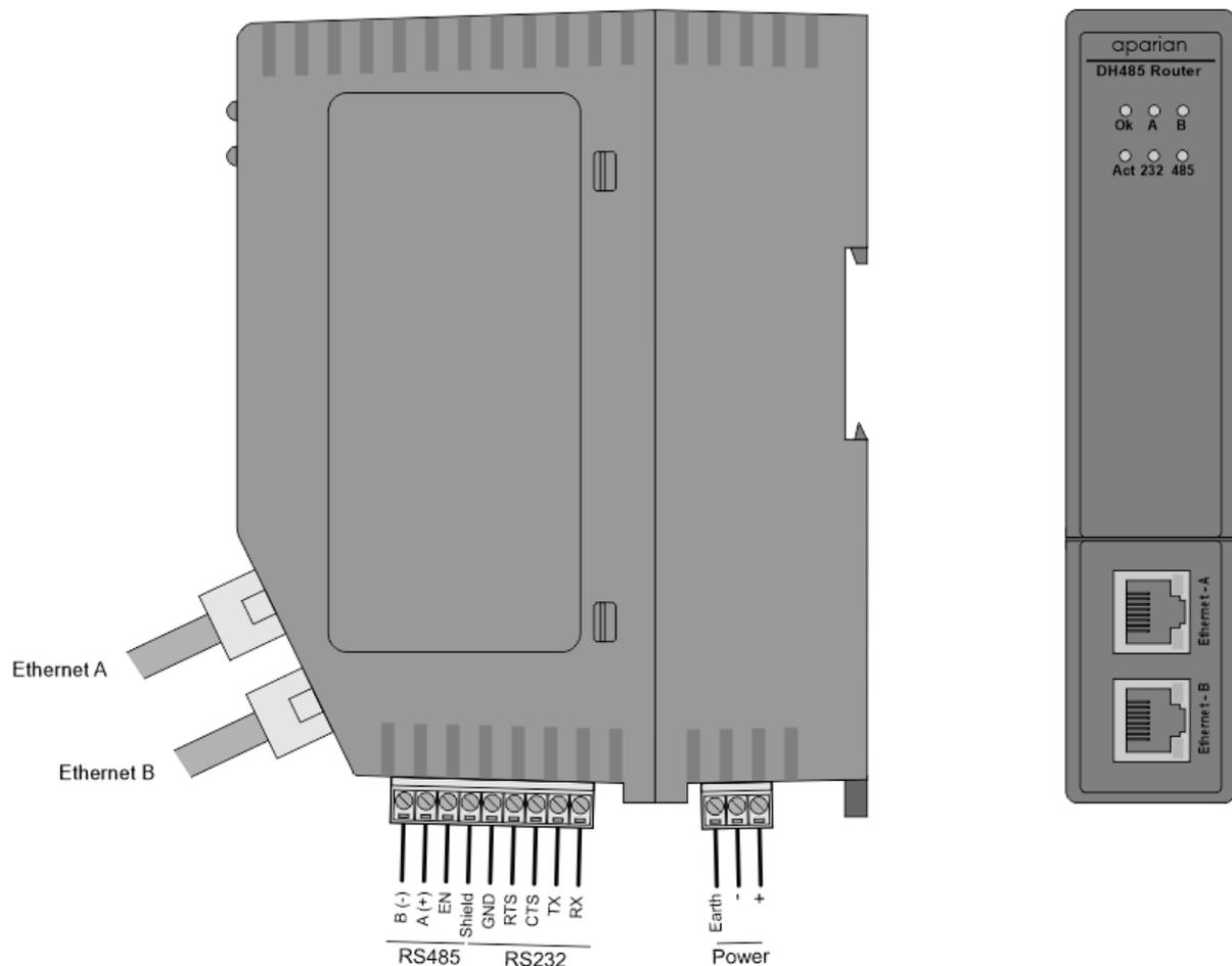
FIGURE 3.1. - DH485 ROUTER/B SIDE AND FRONT VIEW
